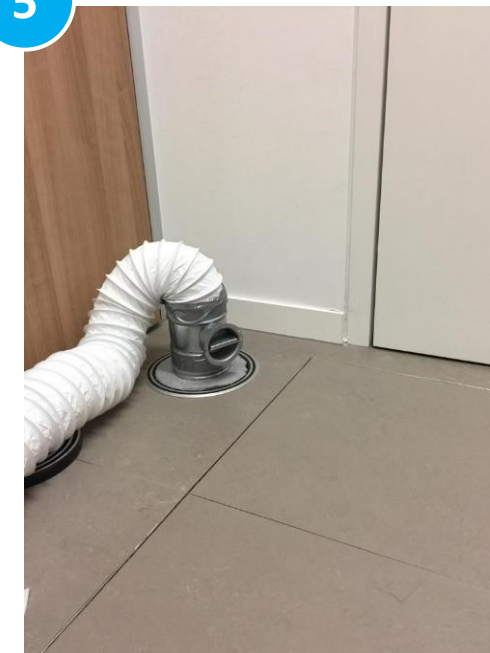
Nutzung des Bypasses zur Erreichung der Zielleckage
