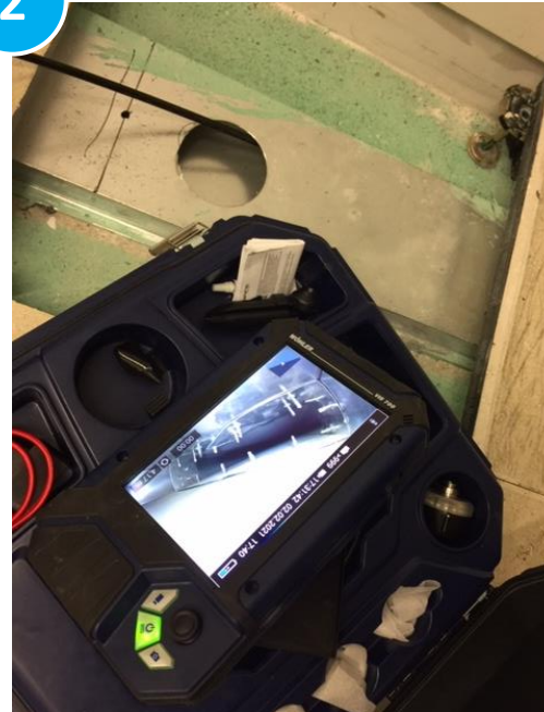
Kamerainspektion zur Identifizierung der Leckagen
